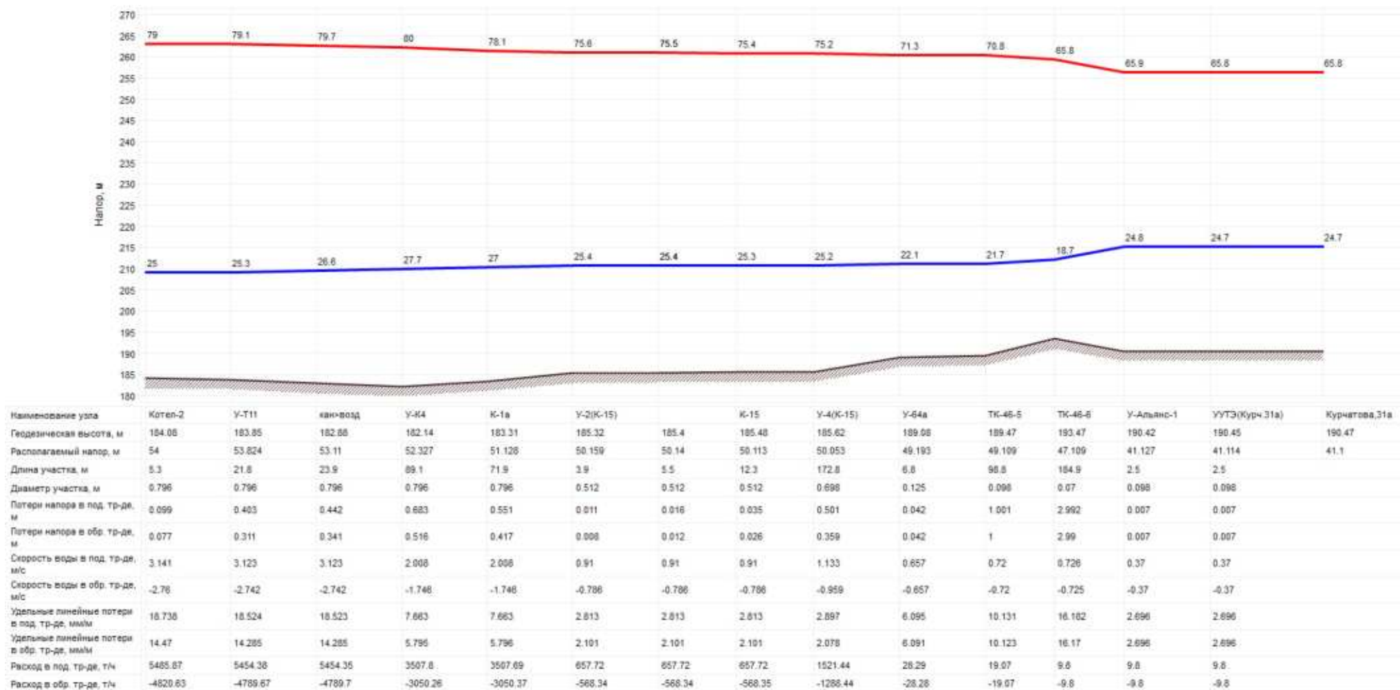
Рисунок 15– - Пьезометрический график от Котельной пр. Коммунальный, 21 до ул. Курчатова, 31а, до отключения участка У-4(К-15) – У-64а
