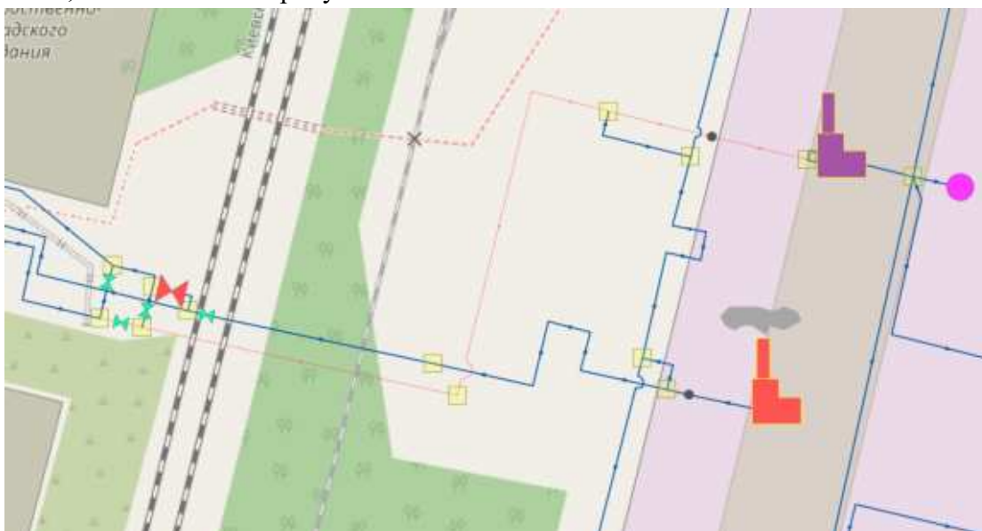
Рисунок 7– – Аварийное отключение Котла №2 и коллектора Ду800
